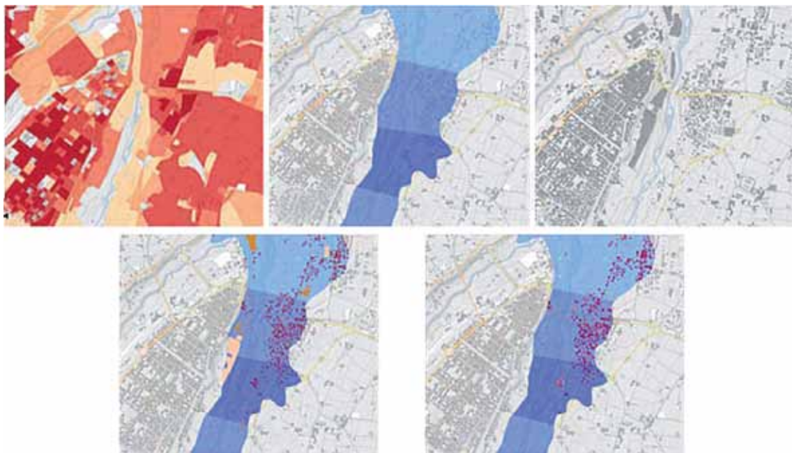
Figura 17. Esempio di elaborazione cartografica utilizzata per stimare il numero di persone coinvolte dall'onda di piena.
